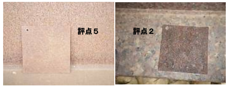
写真-4 さびサンプル使用例
