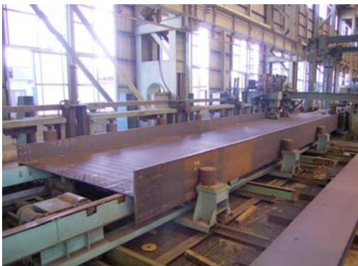
写真-11 I形組立装置(全景)
