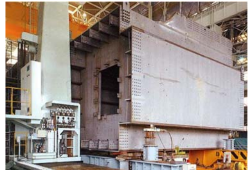
写真-10 フェーシングマシン
