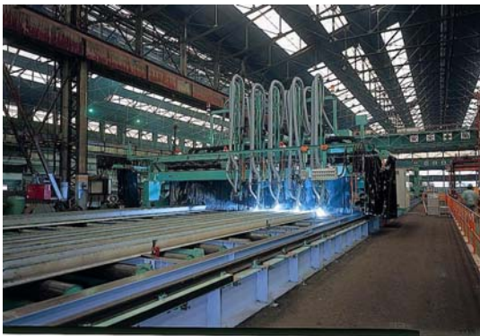
写真-21 大型ガントリー式多電極溶接装置
