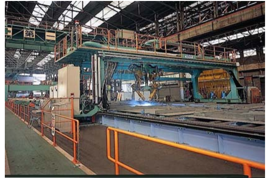
写真-22 多関節溶接ロボット
