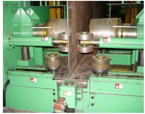
写真-12 I形組立装置(ローラー部)
