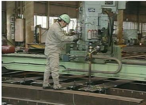
写真-8 ガーターラジアルボール盤
