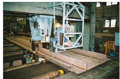
写真-15 パネル矯正機
