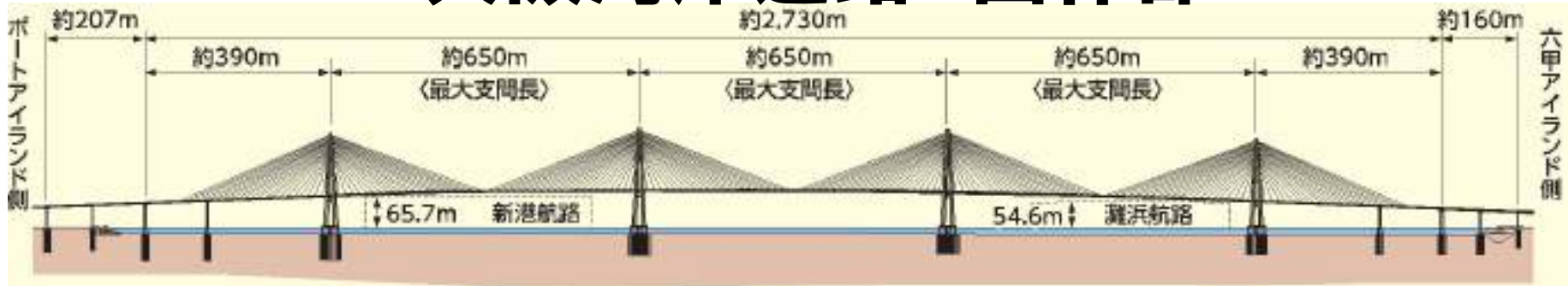
新港・灘浜航路部 (六甲アイランド～ポートアイランド間) 形式: 5径間連続斜張橋(4本主塔)
